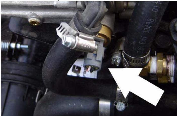
6. Remover o grampo de retenção do sensor de temperatura do GPL e remover o sensor do corpo do regulador.
